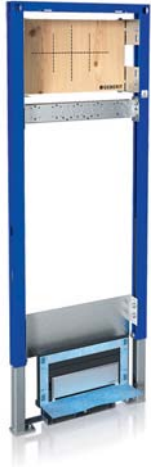
Duofix zuhany szerelőelem falba rejtett lefolyóval fali vagy falsík alatti csaptelepekhez
